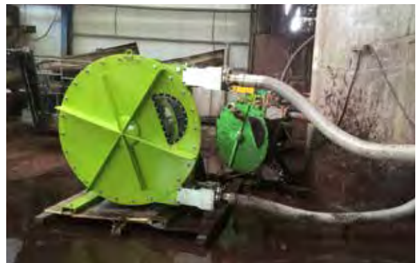
ALH125 wykorzystywana przy recyklingu akumulatorów samochodowych i do przetłaczania ścieków i szlamu
