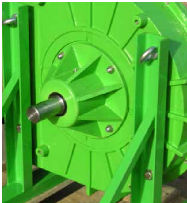
Pompa z odsłoniętym wałem
