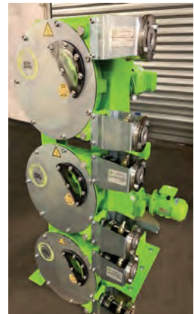
Gestapelte ALH25-Pumpen, verwendet für die Verteilung von Kalkmilch in einer kommunalen Wasseraufbereitungsanlage
