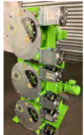
ALH25 堆叠泵组, 用于市政水处理厂的石灰乳投料
