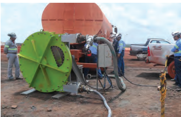
ALH125 para camión de descarga de fertilizantes en agricultura
