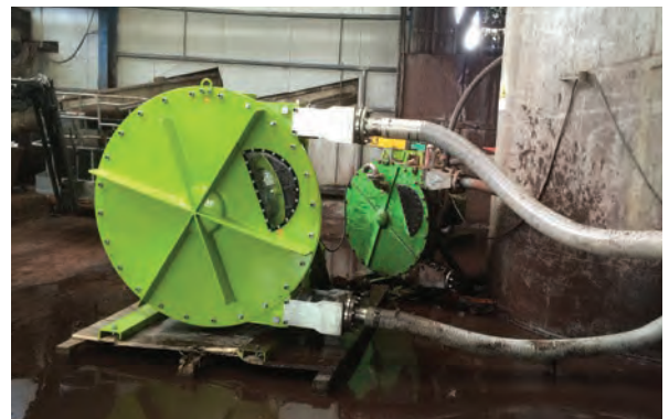
ALH125 para reciclaje de baterías de automóviles, manejo de aguas residuales y lodos
