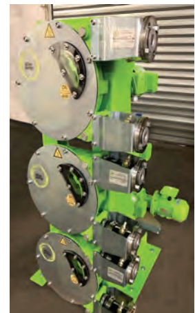
Pompes ALH25 empilées, utilisées pour la distribution de lait de chaux dans une station d'épuration municipale
